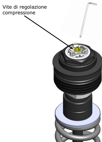
Gambale con la regolazione della compressione (SINISTRO)
